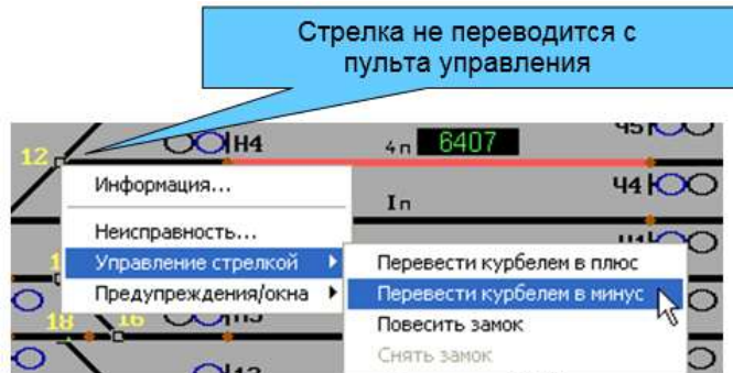
Рис. 14. Перевод стрелки курбелем.
